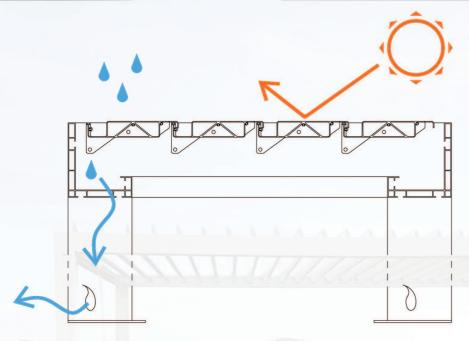
Il sistema portante perimetrale con grondaia integrata permette di raccogliere l'acqua piovana e convogliarla all'interno delle colonne per poi essere scaricata tramite le lavorazioni alla base delle colonne con foro a goccia che contaddistingue il marchio Lesko.
