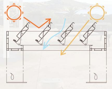
La possibilità di inclinare le doghe in alluminio permette di lasciar filtrare il sole oppure di creare una zona ombreggiata.
